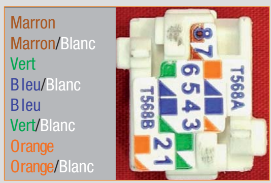
Insertion des fils par le haut
