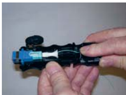
2 - Insérer la fibre
