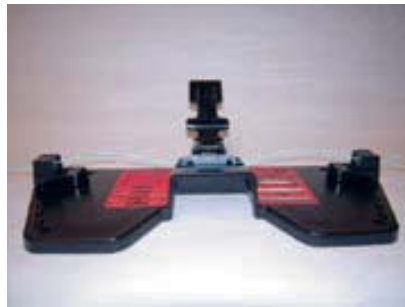
2 - Insérer et équilibrer la fibre
