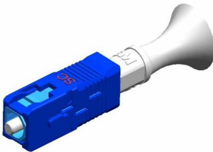
Le NPC est l'association d'un micro pigtail et d'une épissure Fibrlok. Le connecteur pré-fibré en usine intègre une épissure Fibrlok. La procédure de raccordement consiste à insérer la fibre dans le connecteur et déclencher l'épissure Fibrlok
