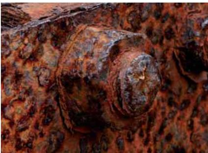
Lorsque deux matériaux conducteurs différents sont en contact, dans un milieu humide, il y a formation d'un couple galvanique. Ceci entraîne un phénomène de corrosion d'un des deux métaux si la différence de potentiel entre ces 2 métaux est supérieur à 0,3V. Le détail des couples à éviter est présenté dans le tableau ci-contre. **Lorsque le couple est indiqué en rouge, le métal considéré est attaqué.**
