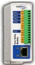
A white, rectangular device with a blue Ethernet port at the bottom, a green terminal block at the top, and a yellow terminal block in the middle. | <p>Relais IP externe - 4 sorties, PoE</p> <p>Dispositif IP autonome pouvant être contrôlé par des commandes HTTP envoyées depuis les Interphones IP 2N, qui peuvent ainsi contrôler des appareils à une distance illimitée.</p>                                                             |
