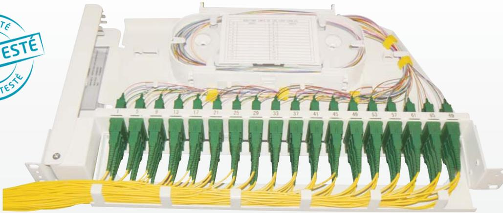
Le tiroir **GGM ODFDUxx** est une tête de câbles optique 1U, permettant l'épissurage et le brassage de 72 fibres optiques. Il s'installe dans des baies 19" ou ETSI.
