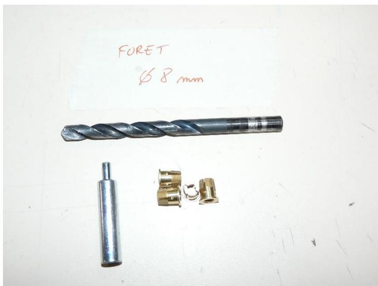
Matériel à utiliser pour fixer le support fibre
