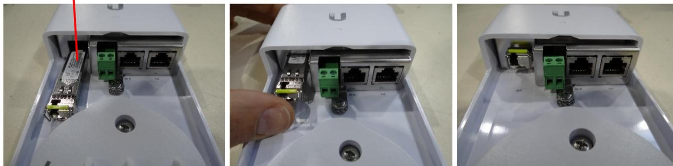
Connecter la jarretière LC/LC entre le convertisseur fibre / RJ45 et le tiroir optique.
