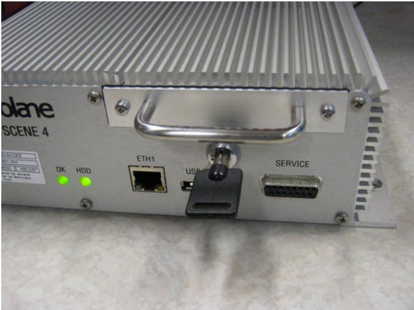
Déverrouiller le tiroir disque dur en tournant la clé vers la gauche et retirer le tiroir disque dur de l'enregistreur.
