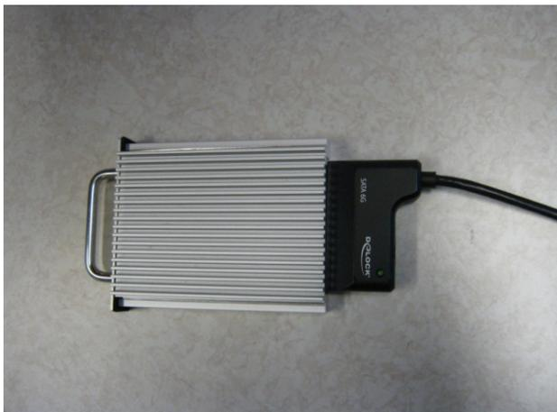
Relier le tiroir disque au PC d'Exploitation à l'aide de l'adaptateur USB – SATA et attendre au moins 30 secondes que le disque soit reconnu par le PC avant de relire les vidéos (bouton « accès disque »).
